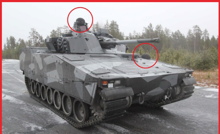
Zweden: CAMEL array op een rubber tracked CV90
