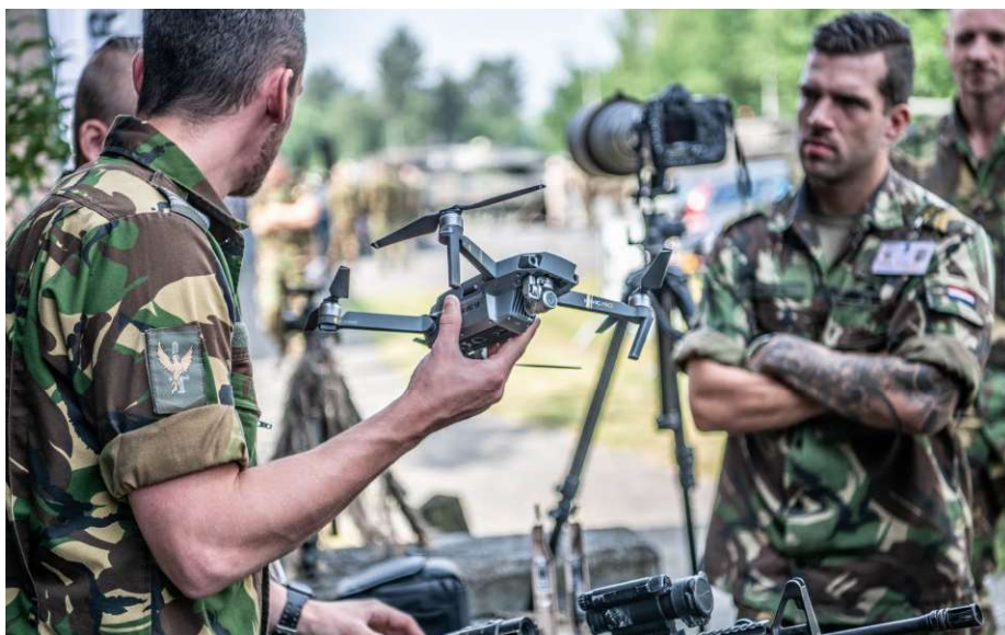
Tijdens diverse oefeningen zijn experimenten uitgevoerd met de mini quad copter DJI Mavic Pro. Ingezet als vliegende camera om ter plekke een betere informatiepositie op te bouwen door waarneming vanuit de lucht.
